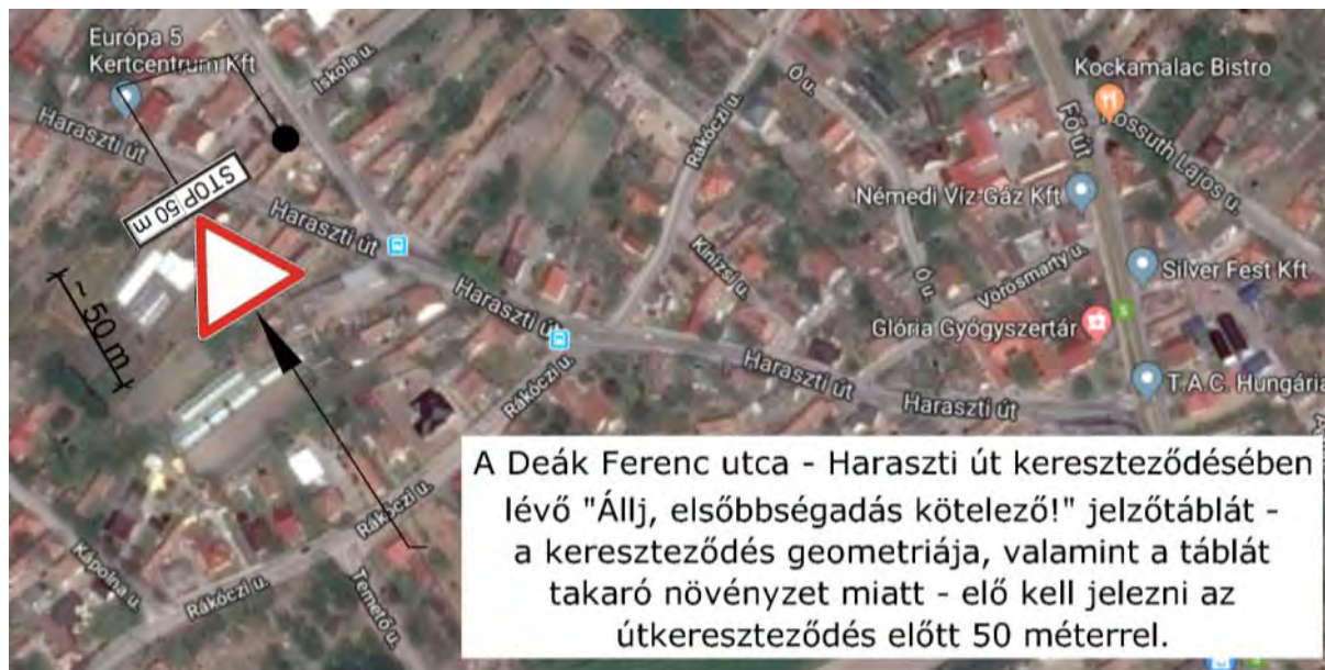
23. ábra: Haraszti út - Deák Ferenc utca kereszteződésében előjelző tábla elhelyezése
