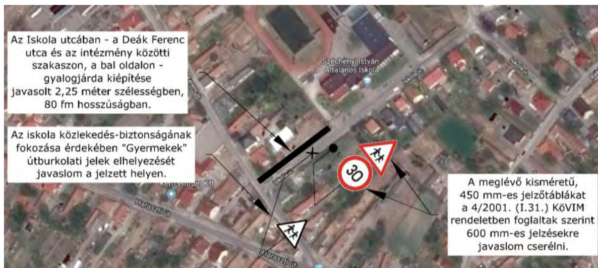
35. ábra: Figyelemfelhívás, járdaépítés az Iskola utcában
