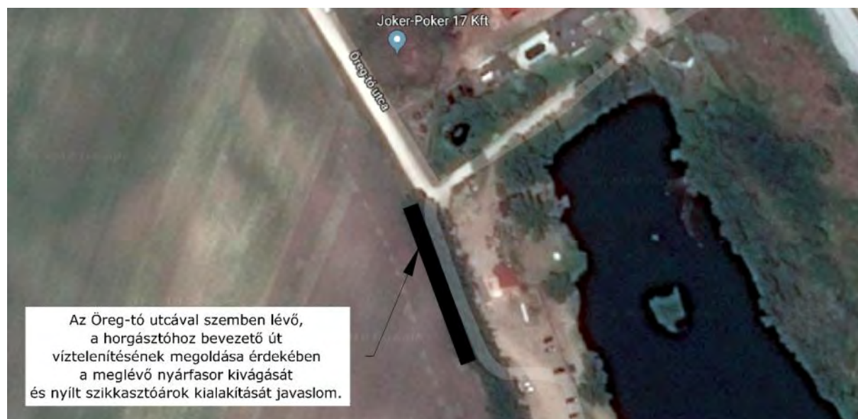
44. ábra: Horgásztó bevezető útjának víztelenítése
