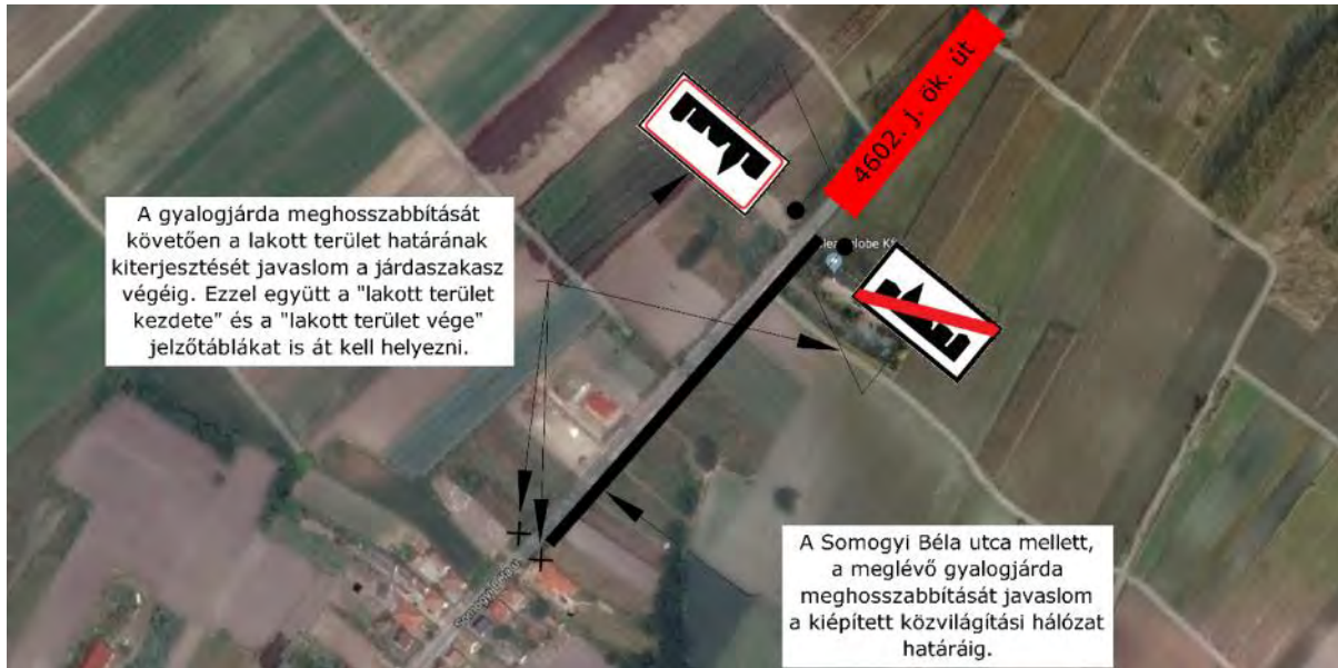
52. ábra: Gyalogjárda építése a 4602. j. ök. út mellett
